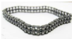
Цепь привода гидравлики Т-24 (2014)
